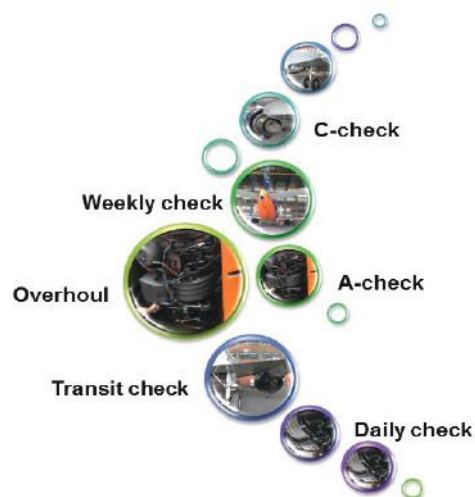
Gambar 2.16 Perawatan berkala pesawat
